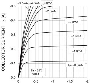
COLLECTOR TO EMITTER VOLTAGE: V<sub>CE</sub> [V]
