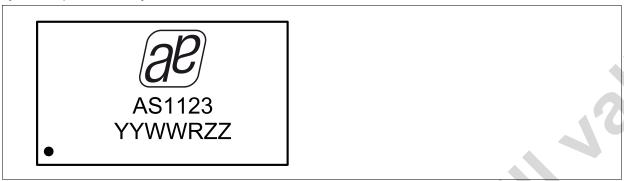
Figure 25. 24-pin TQFN (4x4mm) Marking
