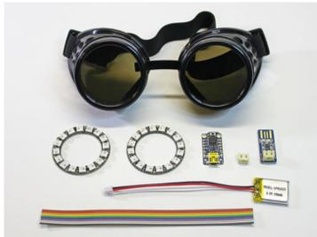
NeoPixel rings (http://adafru.it/dyU), a Trinket microcontroller (http://adafru.it/dyV), JST connector (http://adafru.it/1769), rechargeable 150 mAh LiPoly battery (http://adafru.it/dYY), enough wire for all the connections, plus a USB battery charger (http://adafru.it/doR).
