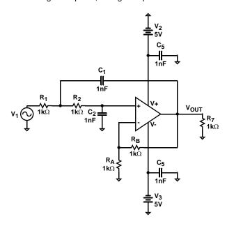
FIGURE 28. SALLEN-KEY LOW PASS FILTER
