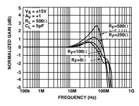
FIGURE 13. GAIN vs FREQUENCY FOR VARIOUS R<sub>FEEDBACK</sub>
