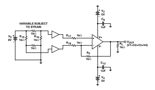
FIGURE 31. STRAIN GAUGE
