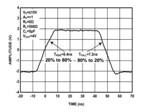
FIGURE 23. LARGE SIGNAL RISE AND FALL TIMES
