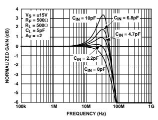
FIGURE 15. GAIN vs FREQUENCY FOR VARIOUS INVERTING INPUT CAPACITANCE (C<sub>IN</sub>)
